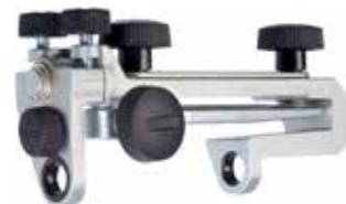
Durch die Konstruktion der Vorrichtung ist es auch möglich, sich verjüngende Meiβel zu positionieren und zu schärfen, z.B. Japanische Stemmeisen. Die Sicherheitsanschläge halten die Vorrichtung sicher auf der Universalstütze und verhindern, dass das Werkzeug von dem Schleifstein rutscht, so besteht keine Gefahr, dass Sie Ihre Finger beim Schärfen verletzen.
