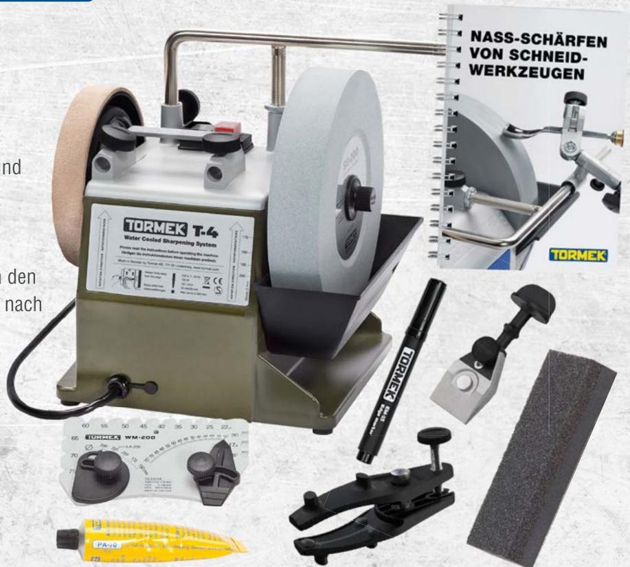
**LIEFERUMFANG:** Die Sonderedition Bushcraft enthält zusätzlich zum Standardzubehör Steinpräparier SP-650, der Winkellehre WM-200, der Abziehpaste PA-70, dem Kantenmarker EM-15 und dem Tormek-Handbuch die Schleifvorrichtung für Messer KJ-45 und die Vorrichtung AX-40 für Äxte.
