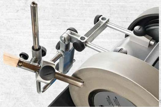
**Bitte beachten Sie, dass der MB-102 nur für das Schärfen mit Tormek Diamant-Schleifscheiben konzipiert ist. Er eignet sich nicht für Schleifsteine, da diese abgerichtet werden müssen, was an der Seite nicht möglich ist.**
